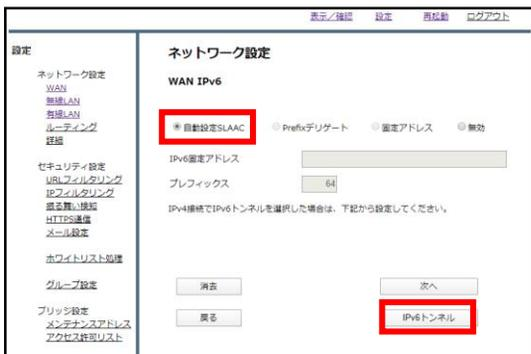
⑧ラジオボタンより”自動設定SLAAC”を選択し、『IPv6トンネル』をクリックします。
