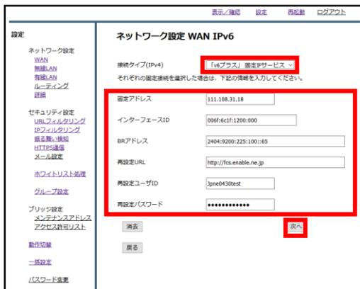
⑨接続タイププルダウンより”「v6プラス」固定IPサービス”を選択し、各入力欄に情報を入力した後『次へ』をクリックします。
