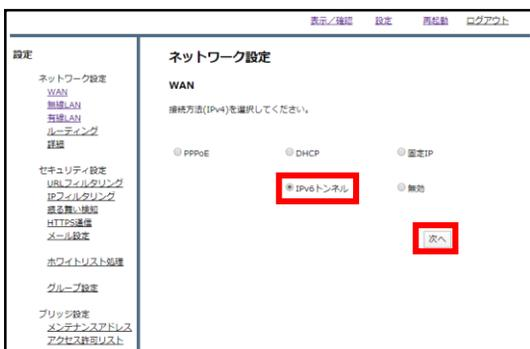
⑥ラジオボタン"IPv6トンネル"を選択し、『次へ』をクリックします。
