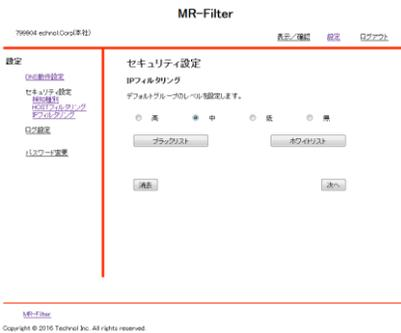
②フィルタリングのレベルをラジオボタンで選択し、『次へ』をクリックします。
